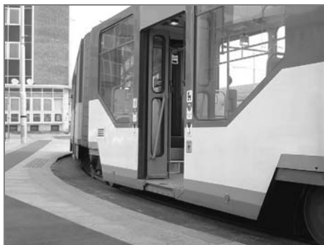
V oblouku nedosáhne sklopná plošina na hranu nástupiště
