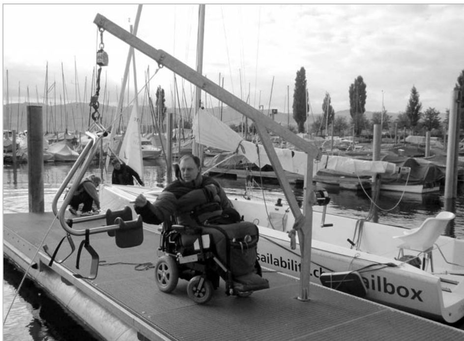
Manipulátor pro přesun vozíčkáře z vozíku na speciální sedačku na plachetnici
