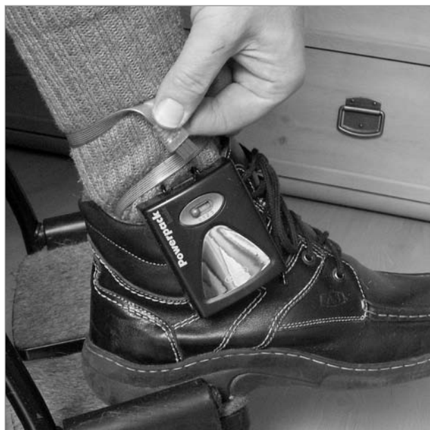
Pouzdro na baterie je opatřeno klipsou k uchycení za horní okraj boty.
