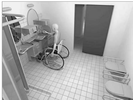
Celkový návrh koupelny handicapovaného, který byl zpracován podle daných norem.
