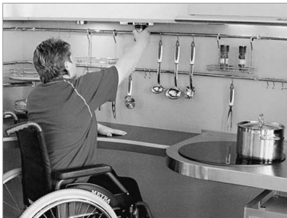
Místo horních skříněk jsou použity otočné karusely a drátěný program. Nádobí je v dosahu a přehledně uspořádané.
