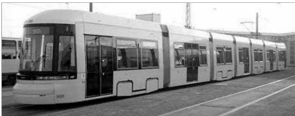
Plošina FLEXITY Berlin není závislá na nástupním ostrůvku.
