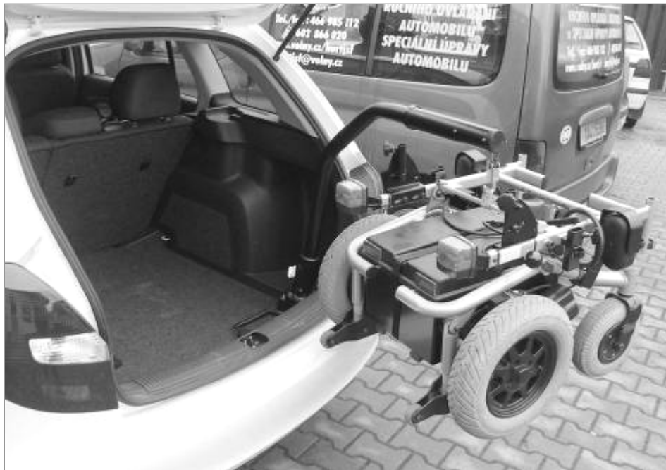
Nakládání elektrického vozíku jeřábkem do kufru Škody Fabie kombi
