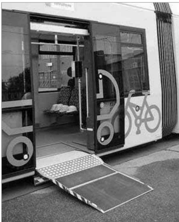
Plošina FLEXITY Berlin není závislá na nástupním ostrůvku.
