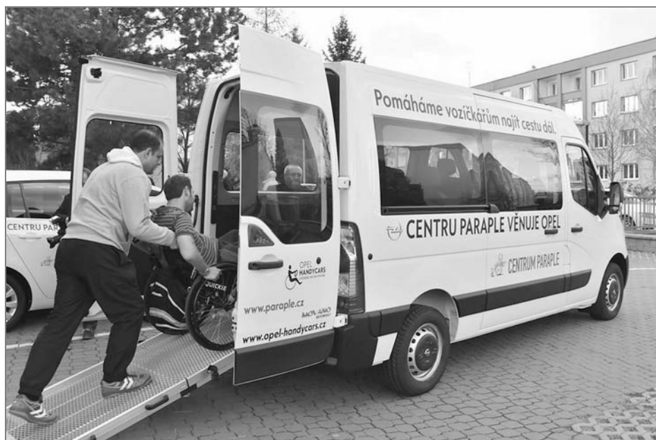
Dodávka Opel Movano je opatřena sklopnou nájezdí rampou
