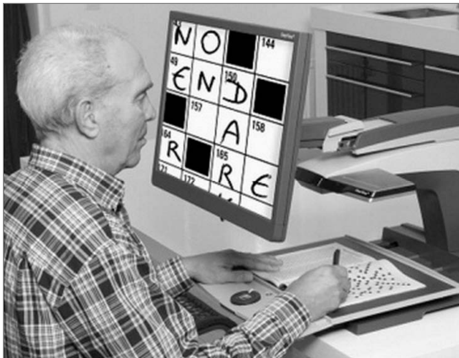
Stolní kamerová lupa snímá předlohu a její zvětšený obraz promítá na monitor
