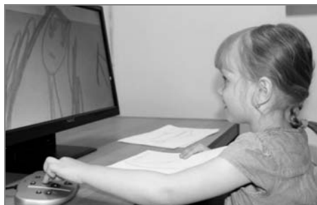
Stolní kamerová lupa snímá předlohu a její zvětšený obraz promítá na monitor
