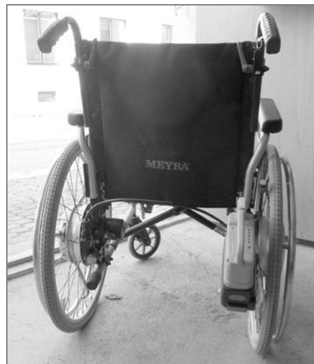
Ilustr. obr.: Akumulátor je umístěn vzadu za zádovou opěrkou
