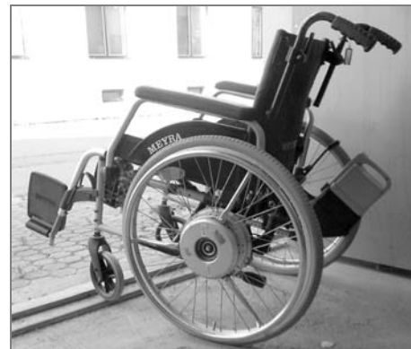
Ilustr. obr.: Vozík s dopohonem Servomatik od fy Meyra
