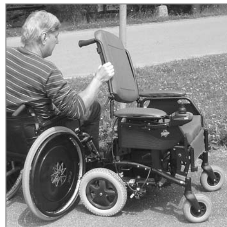
Obr. 3: Postupně nasadím druhou bočnici, sedák a zadní opěradlo.
