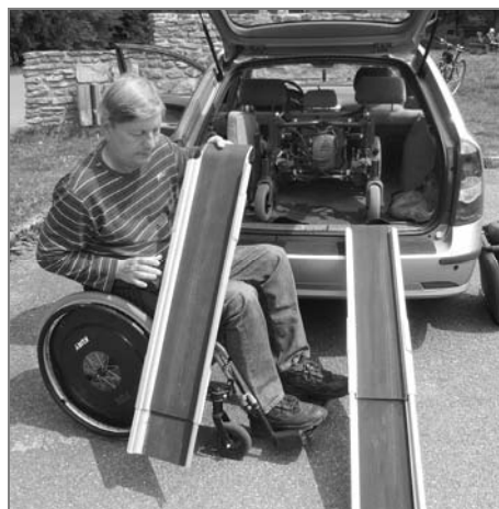
Obr. 1: Nejprve vytáhnou, rozloží a nainstalují ližiny.
