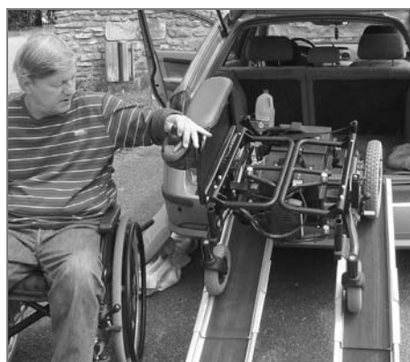
Obr. 2: Spodní pojízdnou část rozloženého električáku vyjedu po ližinách na vozovku. Ovládám ji kniplem v nasunutých bočnicích.
