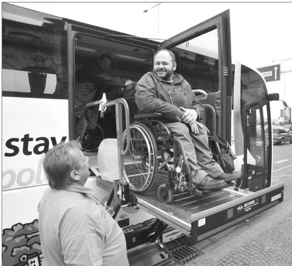
Autobus je vybaven zdvižnou plošinou pro vozíčkáře
