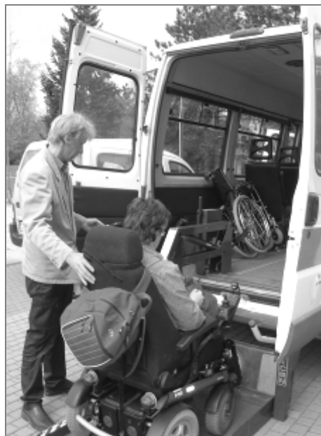
Vozidlo asistované dopravy MEZADO je vybaveno zdvižnou plošinou
