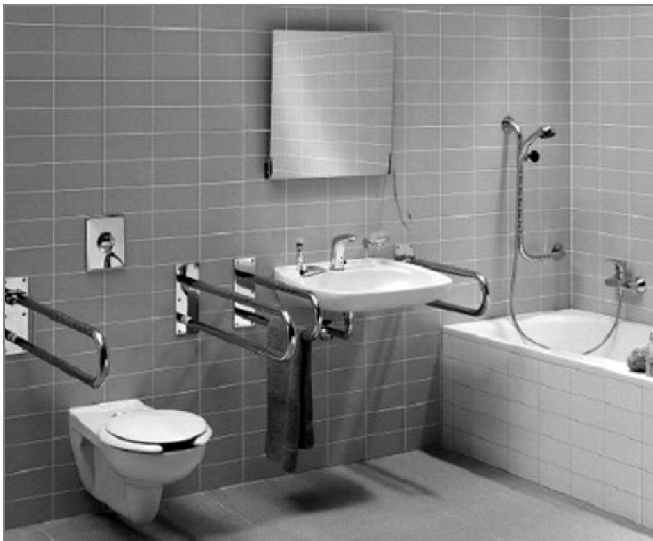
Bezbariérová koupelna s vanou a zavěšenou WC mísou
