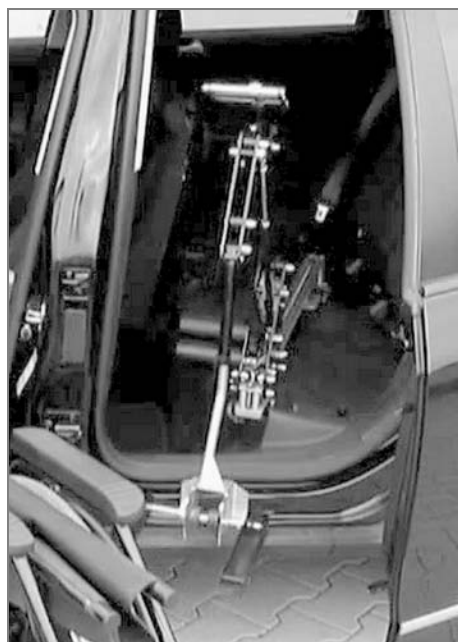
Nakladač ortopedického vozíku do odsuvných dveří automobilu Foto: sken video www.rucniovladani.cz
